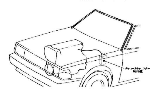
排出ガス抑止装置取付写真
